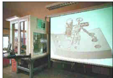
Slovenski (ISKRA) petosni hitrorezaalni stroj Flexmatic X/Z/5 SA 1000 (z delovnim območjem 800 x 600 x 300 mm) v zaščitni komori in motorizirano projekcijsko platno za LCD projektor visoke svetlosti.
