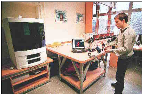
Na levi je »tiskalnik« Stratasys Dimension 3D, na desni pa laserski 3D skener Kreon Zephyr KZ50 na petosni mehanični roki Faro Gold Arm (med laserskim modeliranjem kavlja).
