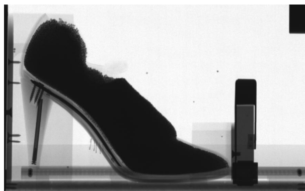
Slika 1: Rentgenski posnetek ženske obutve velikosti 892x551 slikovnih točk z vidnim krogličastim granulatom in oporami.
