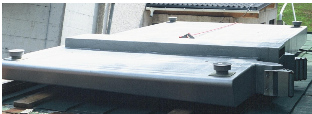
Slika 4.12: Končna oblika poliesterskega rezervoarja
